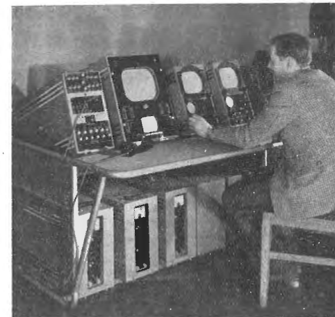
Banco di controllo per l'installazione di televisione alla Fiera delle Industrie Britanniche (625 linee).
